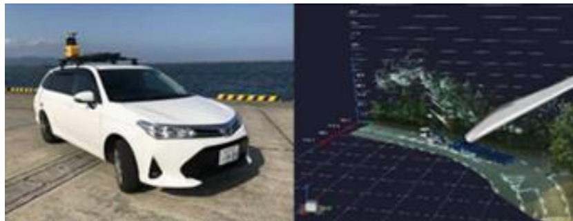
3Dスキャナを搭載した計測車輛
