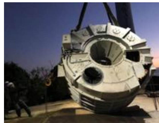
解体した風車の発電機
